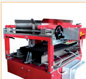
Decatastatore Tipo4 per seminiere, porta vasi/ vaschette in termoformato leggero
