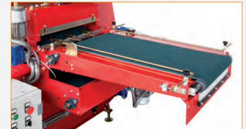
RME63C Nastro di sincronizzazione e nastro recupero torba Synchronizing and soil recovery belt Cinta sincronizadora y cinta de recuperación turba
